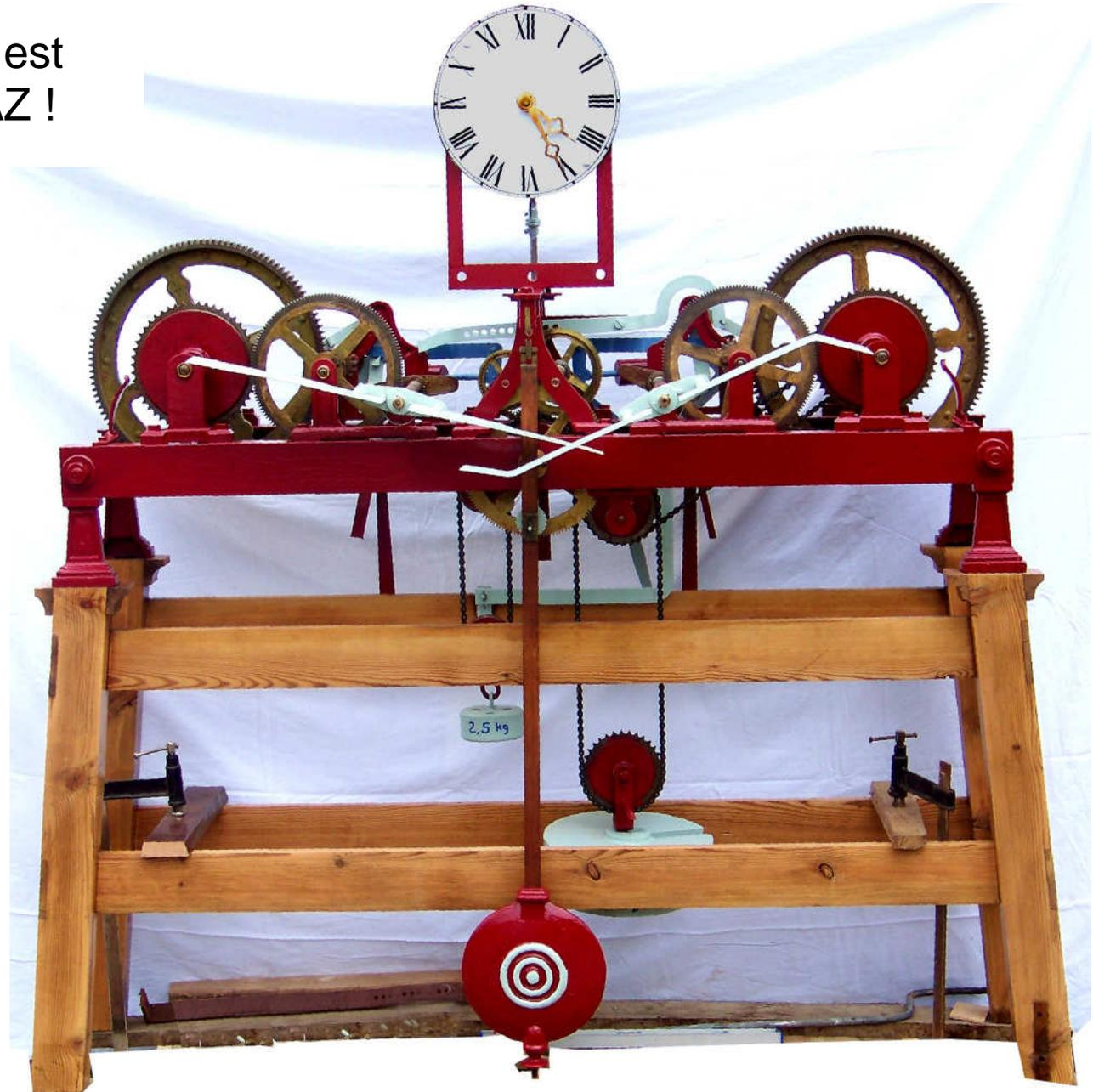
Le mécanisme central donne les heures, celui de gauche contrôle les sonneries des demi-heures et celui de droite les sonneries des quarts d'heure. On remarquera les deux jeux d'ailettes destinés à ralentir la cadence des sonneries.
